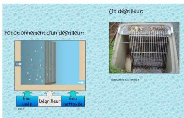
Schéma de principe du dégrilleur
